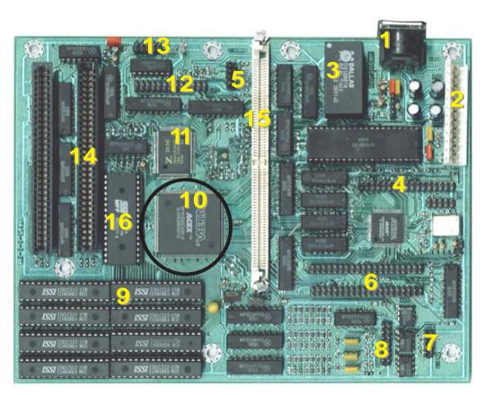
TOP -The Sprinter board : 1) AT Keyboard Connector, 2) AT Power Connector, 3) Dallas Real Time Clock and CMOS, 4) Floppy Disk Connector, 5) Joystick / Tape Connector, 6) IDE Connectors, 7) Sound Connection, 8) Video Connector, 9)Video RAM, 10)Altera PLD, 11) CPU, 12) Printer Connector, 13) Mouse Connector, 14) 8bit ISA Slots, 15) SIMM RAM Connector, 16) Sprinters BIOS.
